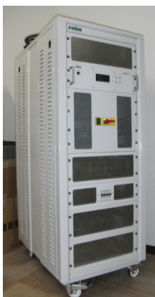
【PRANA社製(フランス) RFアンプ】 アンテナと組み合わせて電磁波を放射し、電磁波 をあてられた自動車、電化製品等の機器が誤動作 しないかを試験する
