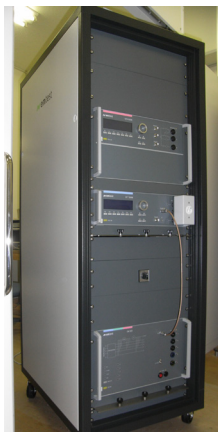
【EM TEST社製(スイス) サージシジェネレータ】 疑似的に雷を発生させ、電源ライン・信号ライン を通して情報機器や電化製品等が誤作動、故障し ないかを試験する
